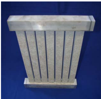
Bild 1: Demonstrator 01 (links) mit aufgelöteten Faserstreifen vor der Beschichtung mit Zeolith. Demonstrator 02 (rechts) nach Zeolith-Beschichtung.
