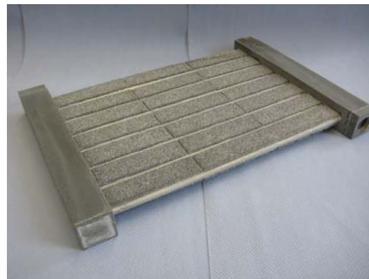
Bild 1: Demonstrator 01 (links) mit aufgelöteten Faserstreifen vor der Beschichtung mit Zeolith. Demonstrator 02 (rechts) nach Zeolith-Beschichtung.
